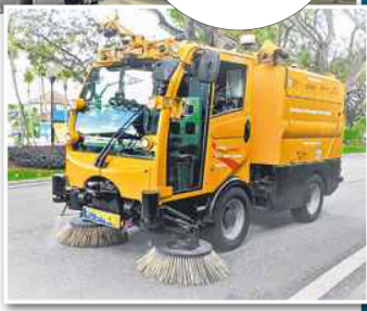
▲▼操作员不在现场，但可利用5G技术远程操作自动环境服务车进行道路清扫。（新电信提供）
